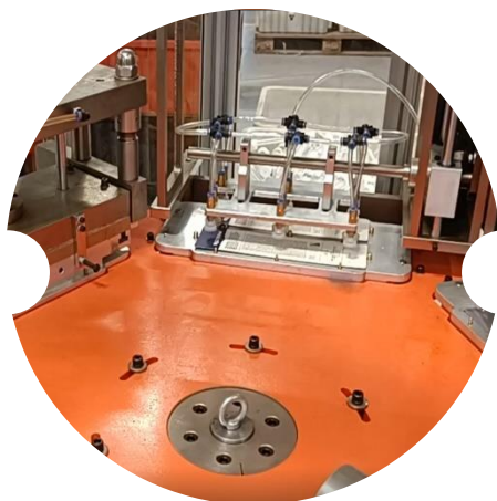
Automatyczne pakowanie produktów w termoformowany blister
