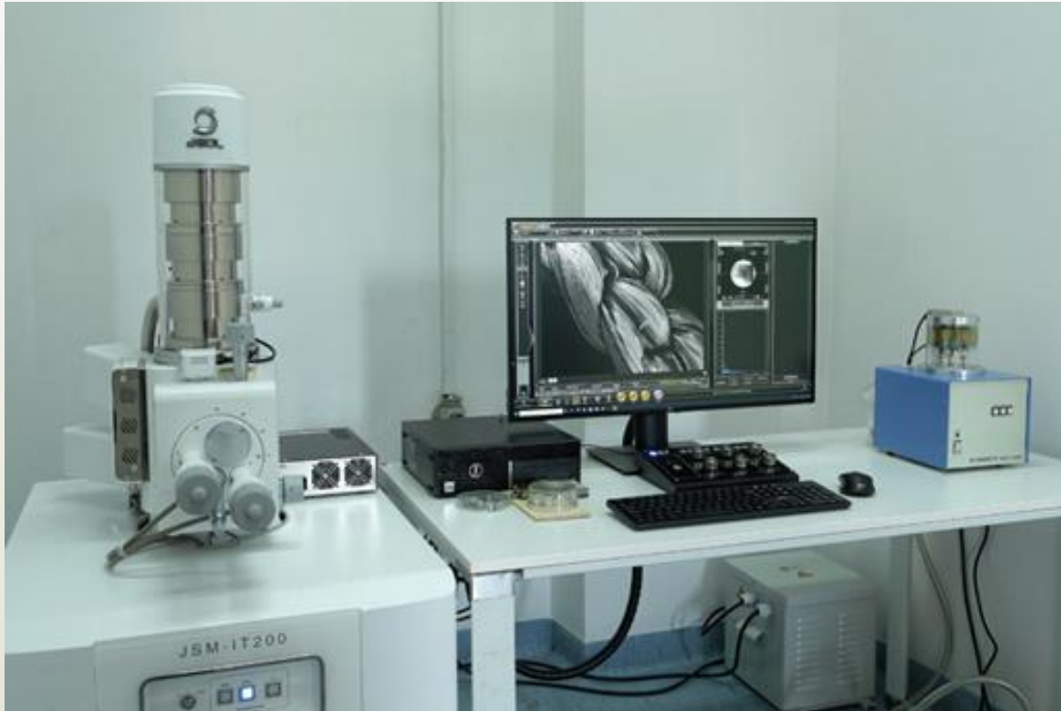
Elektronowy mikroskop skaningowy JEOL JSM-IT200LV In-Touch-Scope™
