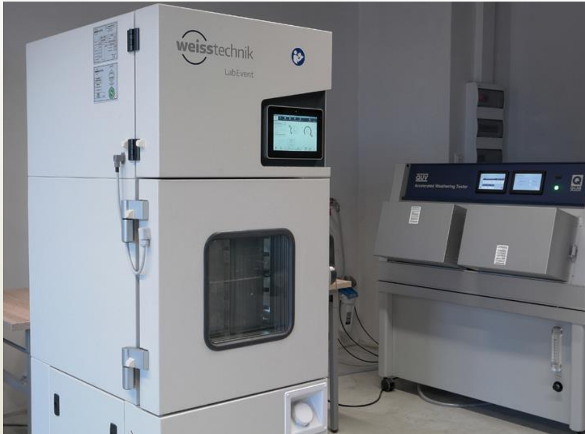
Komora klimatyczna z regulacją wilgotności, zakres temp. -40 do +180 oC. WeissTechnik LabEvent L C/34/40/5 oraz komora do przyspieszonych badań starzeniowych (w głębi).
