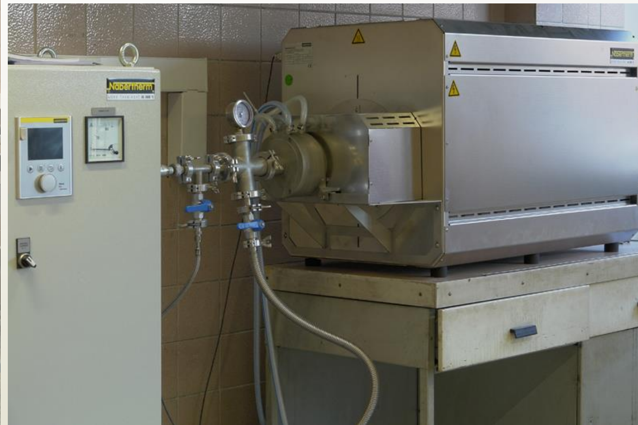
Piec rurowy wysokotemperaturowy RHTH
